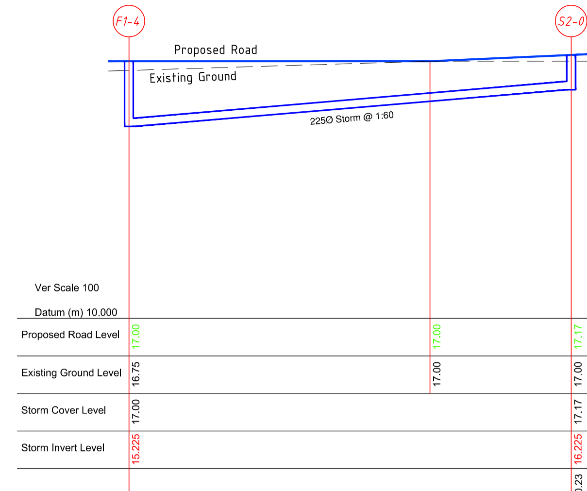
Longitudinal Section S2-0 - S1-4 Scale: V-1:500 H-1:100
